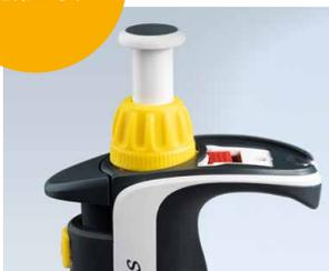
易校准技术: 无需工具调节移液器
