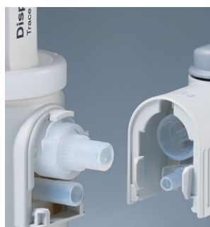
无需密封圈的阀门设计
