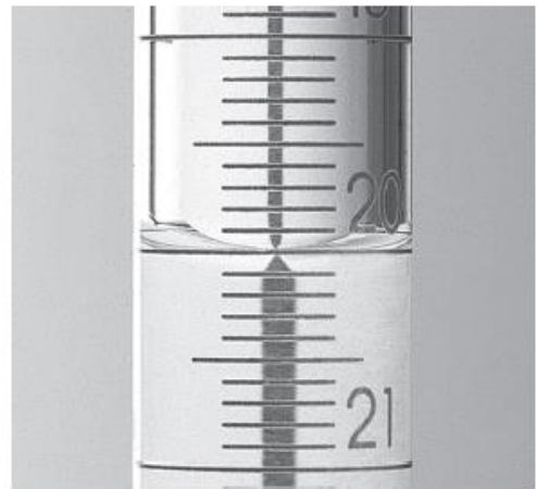
通过Schellbach条标记调整凹液面
